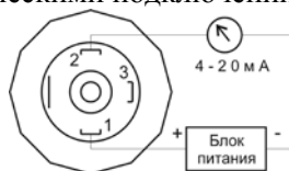
Рисунок 2 - Схема электрическая подключений преобразователей
