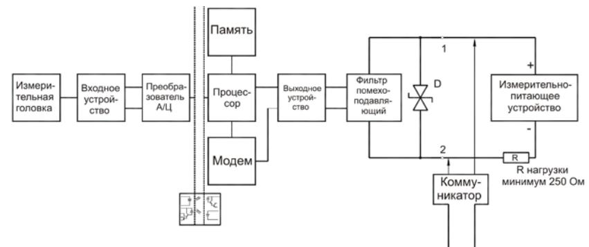
Рисунок 1 – Блок-схема преобразователя
