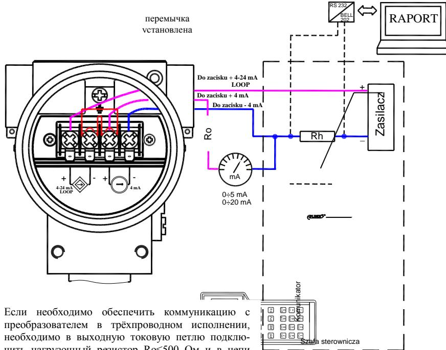
Если необходимо обеспечить коммуникацию с преобразователем в трёхпроводном исполнении, необходимо в выходную токовую петлю подключить нагруженный резистор  $Ro \leq 500$  Ом и в цепи питания резистор  $Rh \geq 240$  Ом. Коммуникация в трёхпроводном исполнении реализуется только на контактах резистора  $Rh$ . Уровень ошибок коммуникации в трёхпроводном исполнении может быть несколько выше чем в двухпроводном исполнении.
