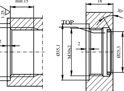
Рисунок Б.3б - Ответное гнездо для присоединений типа CM30x2 с лицевой мембранный
