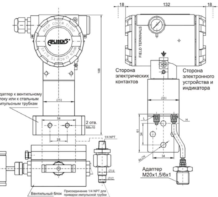
Рисунок 8 - Преобразователи APR-2000G/ALE с различными элементами присоединения
