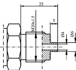
Рисунок Б.1а - Присоединение манометрическое M20x1,5 типа М
