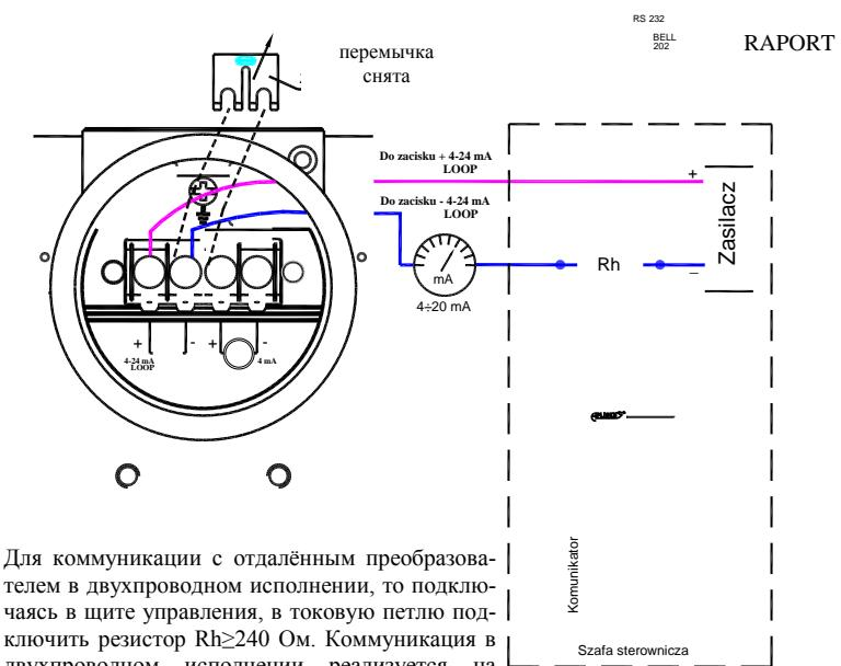
Для коммуникации с удаленным преобразователем в двухпроводном исполнении, то подключаясь в щите управления, в токовую петлю подключить резистор  $R_h \geq 240$  Ом. Коммуникация в двухпроводном исполнении реализуется на контактах резистора  $R_h$ .
