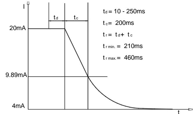
Преобразователь с выходом от 4 до 20 мА, время реакции на изменение (бросок) давления  $t_r$ , цикл измерения 0,5 с, постоянная времени задержки (damping) = 0
