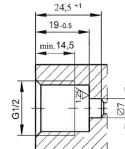
Рисунок Б.4b - Гнездо для монтажа преобразователей с присоединением типа G1/2
