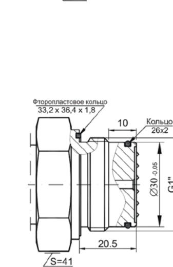
Рисунок Б.4e - Присоединение с лицевой мембранный типа CG1 с резьбой G1"
