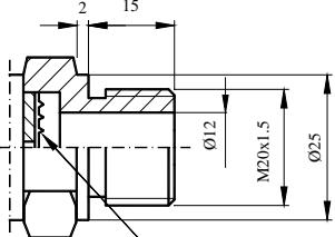
Рисунок Б.2а - Присоединение M20x1,5 типа Р с увеличенным отверстием
