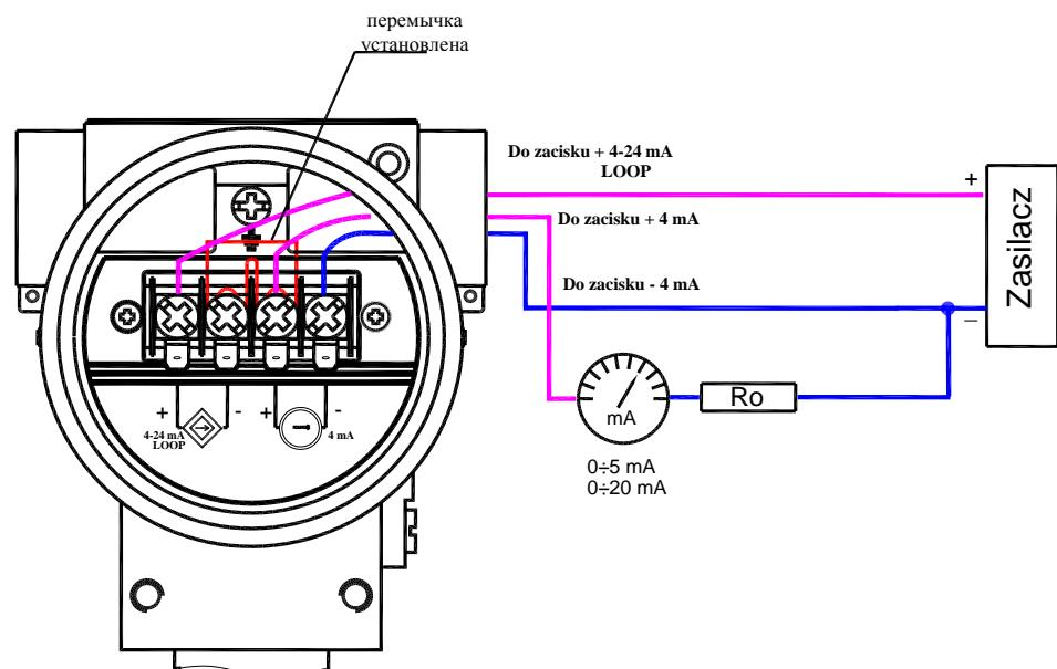
При увеличении значения сопротивления в токовой петле, для обеспечения возможности коммуникации, необходимо убедиться, что падения напряжения на подключенном сопротивлении  $R_o$ ,  $R_h$  включенном в токовую петлю, не приведут к падению напряжения на контактах преобразователя ниже требуемого значения минимального напряжения питания.
