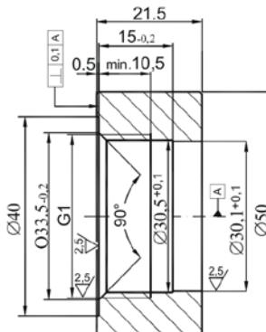
Рисунок Б.8f - Кольцо для монтажа присоединений типа CG1 с лицевой мембранный
