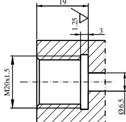
Рисунок Б.1б - Ответное гнездо для преобразователей с манометрическим присоединением M20x1,5 типа М
