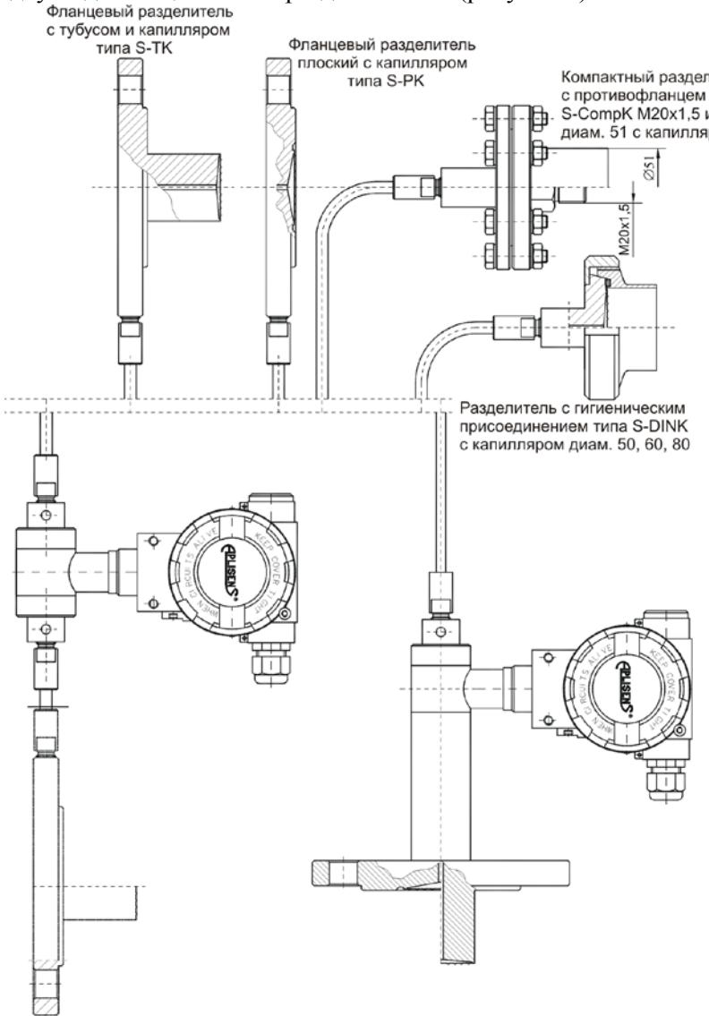
Рисунок 6 - Преобразователи APR-2200ALE с двумя дистанционными разделителями
