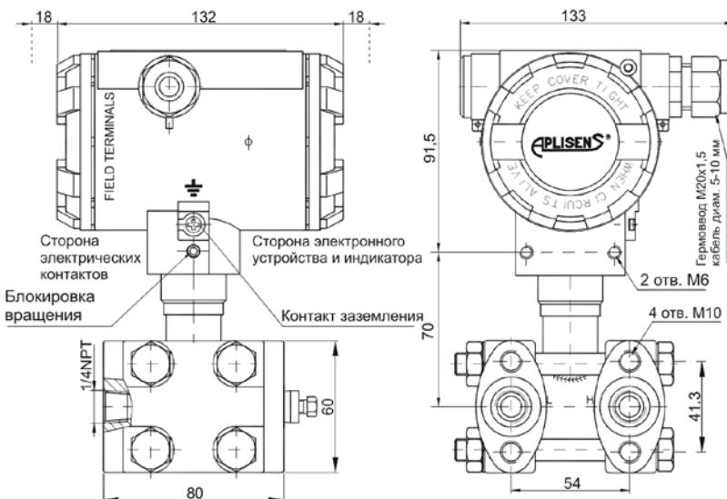
Рисунок 4 - Преобразователи APR-2000/ALE с присоединением типа С
