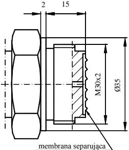
Рисунок Б.3а - Присоединение с лицевой мембранный M30x2 типа CM30x2
