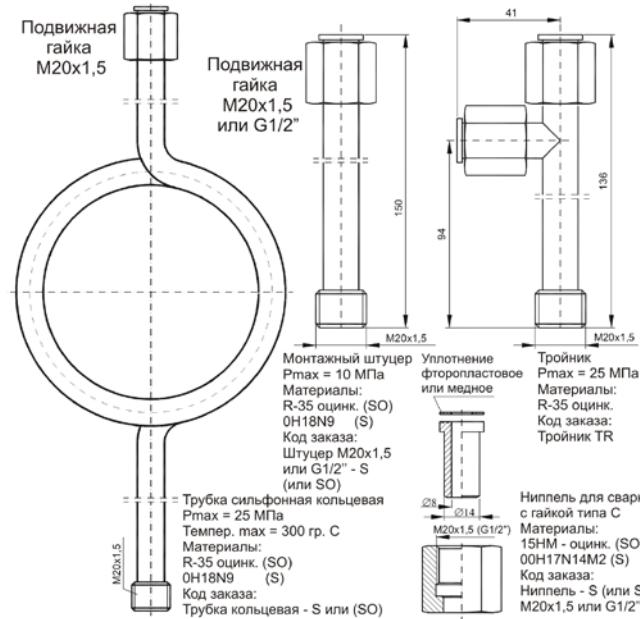
Рисунок 15 – Дополнительное оборудование для монтажа преобразователей APC-2000/ALE
