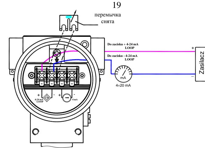
Рисунок 12 – Схема электрического подключения преобразователей двухпроводного исполнения
