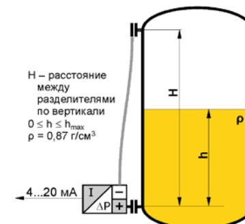
1. Установить преобразователь в рабочем положении на пустом резервуаре.
