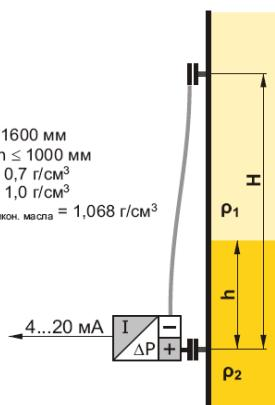
Определение величины начала измерительного диапазона состоит в расчете разности давлений, устанавливающейся на преобразователе при наполнении резервуара исключительно легкой жидкостью:
